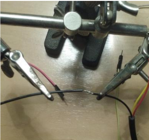
Figure 20 : deux fils prêt à être soudés
