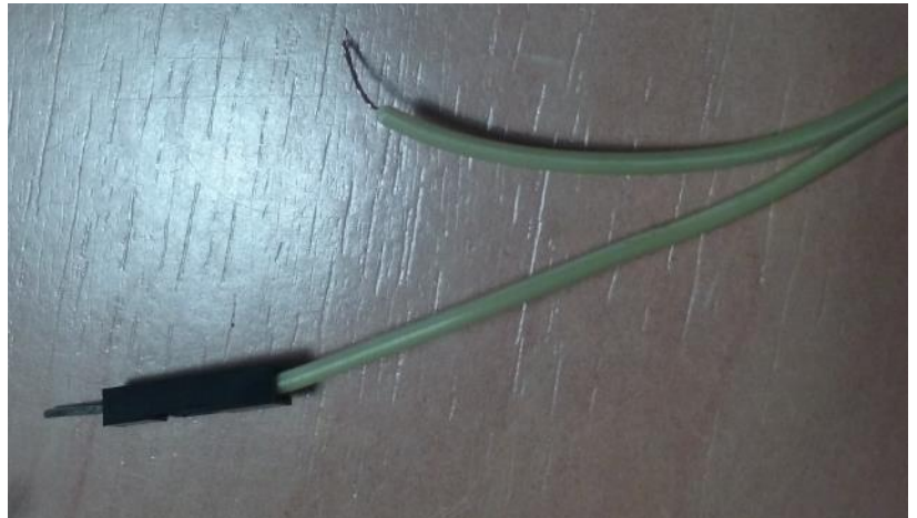
Figure 19 : fils dénudé d'un côté
