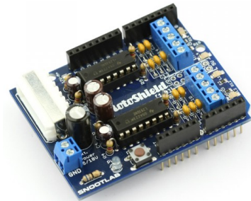
Le RotoShield de chez Snootlab, basé sur 2 x L293.
