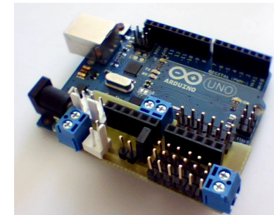
Exemple d'un mini-shield à connecteurs droits 0V / +5V / Broche réalisé par www.mon-club-elec.fr
