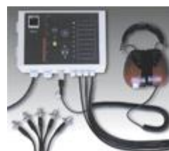
Boîtier électronique permettant de suivre le bruit de 8 paliers
