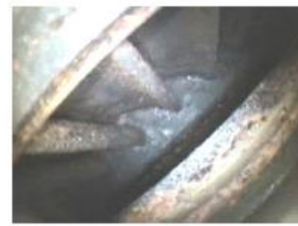
Vidéoscopie : contrôle d'une turbine à vapeur
