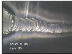
Vidéoscopie : contrôle de soudure inox
