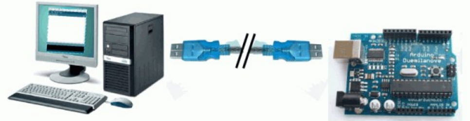
Communication par le port USB pendant l'exécution du programme !
