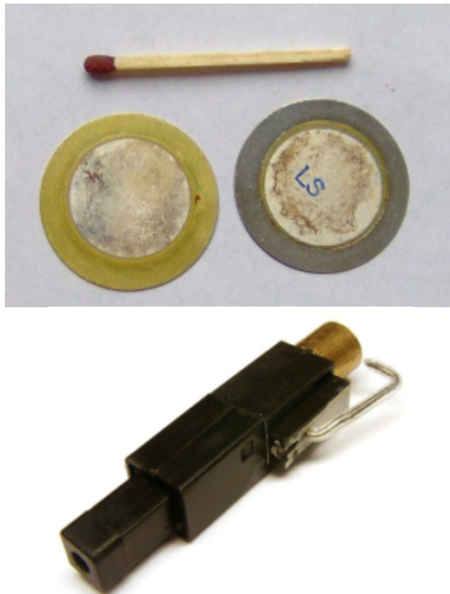
Éléments piézoélectriques de montre à gauche et allumeur de briquet à droite – source Wikipédia
